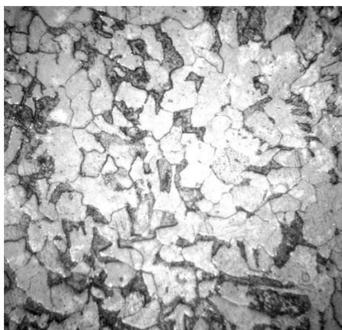
Рисунок 4 – Микроструктура сварного соединения приварки штуцера на коллекторе пароперегревателя
