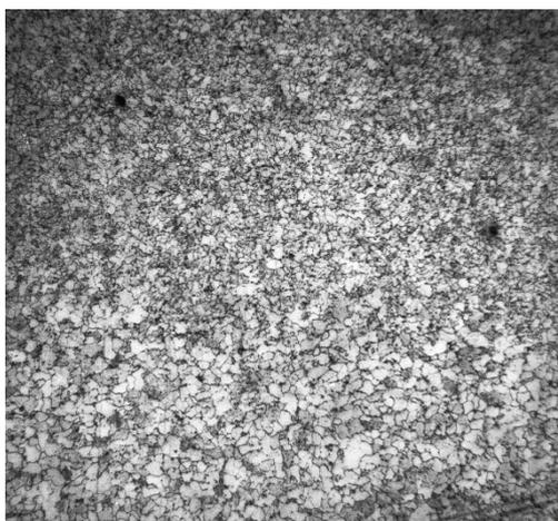
Рисунок 3 – Микроструктура металла сварного стыка №5 при увеличении  $\times 500$
